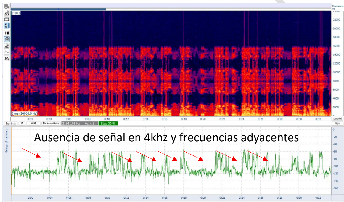
Figura 21. Análisis de continuidad para frecuencia de 4khz
