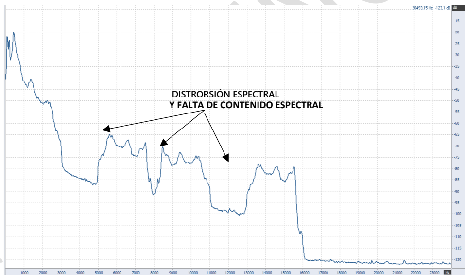
Figura 17. Análisis espectral FFT de la señal de audio
